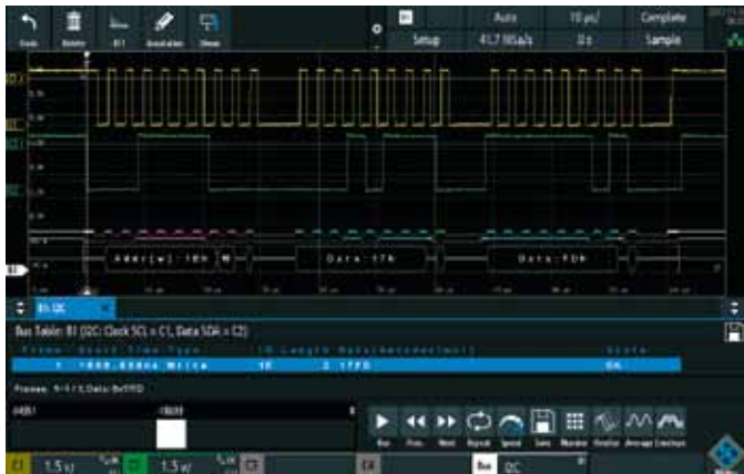
已解碼的 I 2 C 訊號包含類比波形(使用R&S®RTM3000)
