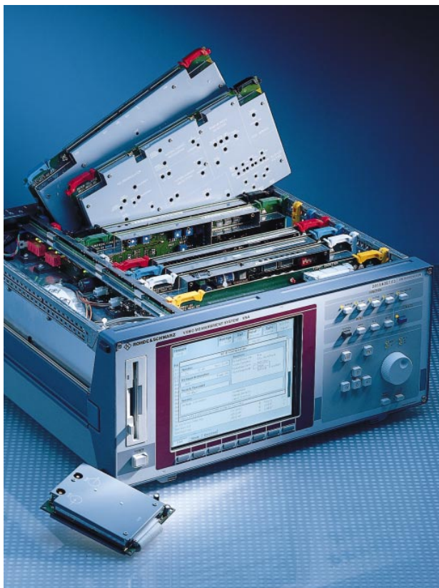
BILD 1 Mit eingebauter Meßempfangen-Option unterstützt das Video Measurement System VSA die speziellen Meßbedürfnisse rund um die TV-Sender und Kabelanlagen (auf dem Bildschirm das Konfigurationsmenü des Meßempfängers). Foto 42 329/2
