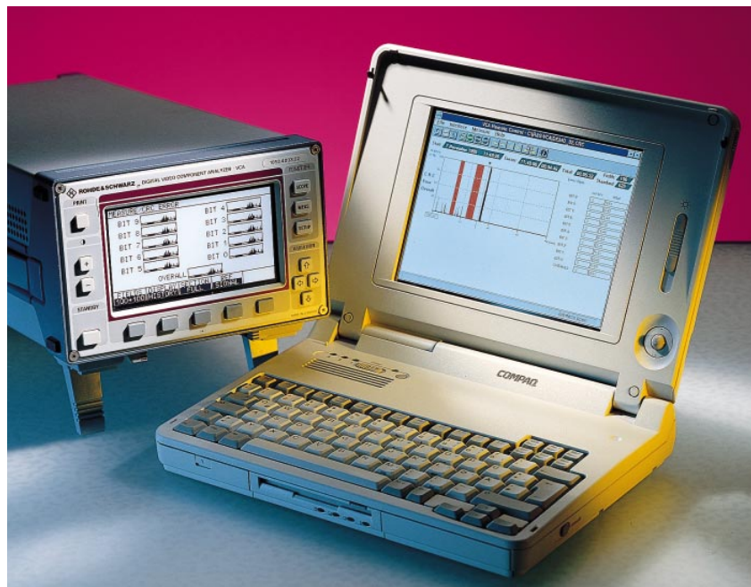
BILD 1 Zusammen mit einem PC kann der Digital Video Component Analyzer VCA digital-serielle Videosignale rund um die Uhr überwachen. Foto 42 331
