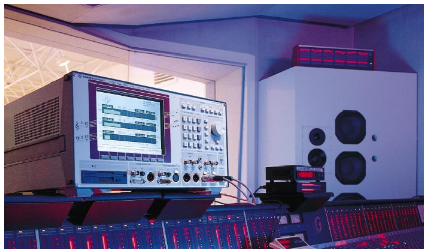
BILD 1 Audio Analyzer UPD bei der Messung von Lautsprechern im Tonstudio. Foto 41 751/7
