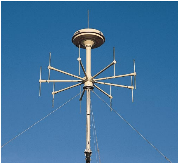
BILD 5 VHF-UHF-Peilantenne ADD051 (20 bis 1300 MHz, Korrelation). Foto 42 334/1
