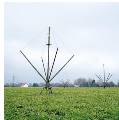
BILD 4 HF-Peilantenne ADD011 (0,3 bis 30 MHz, Korrelation). Foto 42 342
