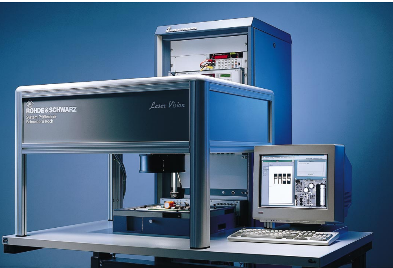
BILD 1 Kombination von Board-Testsystem TSA und LaserVision System LV1 beim elektrischen und optischen Test einer gedruckten Schaltung. Foto 41 878
