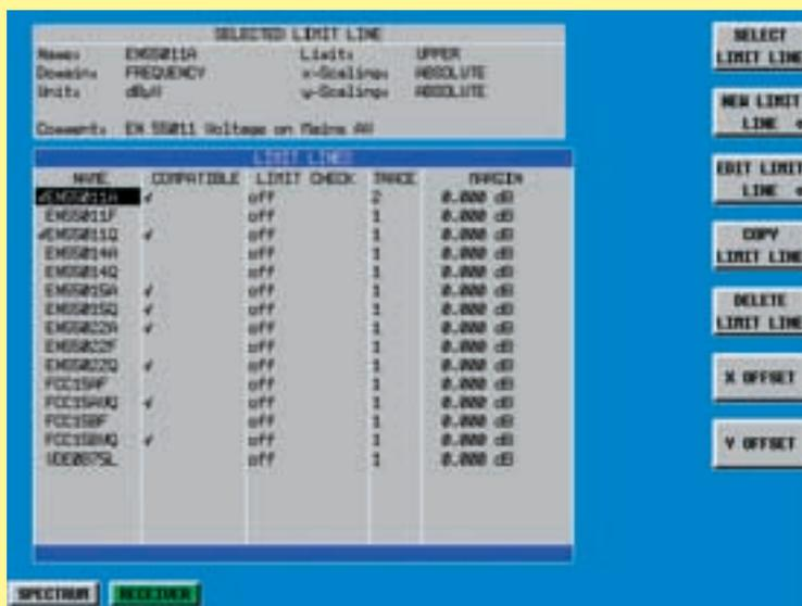
**BILD 2** Der ESPI unterstützt das komfortable Generieren und Speichern einer nahezu beliebigen Anzahl von Grenzwertlinien mit bis zu 50 Stützstellen je Linie. Jede Grenzwertlinie kann einer der drei Messkurven fest zugeordnet werden. Weiterhin kann ein Sicherheitsabstand zur Grenzwertlinie (MARGIN) vorgegeben und überwacht werden (LIMIT CHECK). Die Grenzwerte der wichtigsten kommerziellen Standards sind bereits programmiert.
