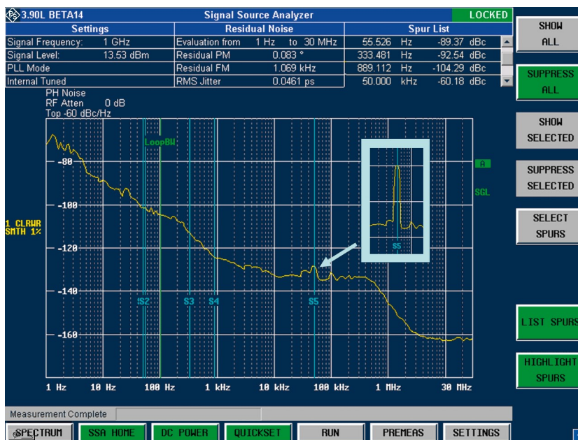
BILD 3 Typische Messung mit der Phasenkomparatormethode: Am Display sind Signalfrequenz, Pegel und Residual Noise abzulesen. Ungewollte Störlinien erkennt der R&S®FSUP automatisch, sie lassen sich ausblenden. Auch eine Liste der Störlinien (rechts oben im Display) mit genauer Frequenzangabe wird eingeblendet.
