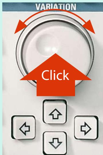
**Fig. 4** Le bouton rotatif qui fonctionne aussi comme bouton-poussoir permet de naviguer confortablement dans les panneaux.
