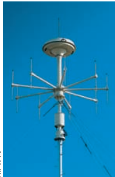
BILD 3 Die korrelativen Interferometerantennen ADD051 (= ADD 050 mit ADD 150) und die ADD070 (Zylinder unten) decken zusammen den Frequenzbereich von 20 MHz bis 3000 MHz ab.
