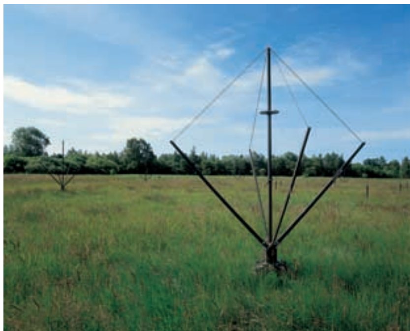
BILD 1 Interferometer-Peilantenne ADD011, kombiniert mit der Adcock-Antenne ADD012 (Monopole im Bildhintergrund rechts).
