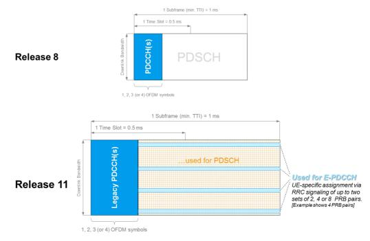
Fig. 2-12: PDCCH (Rel-8) versus E-PDCCH (Rel-11)
