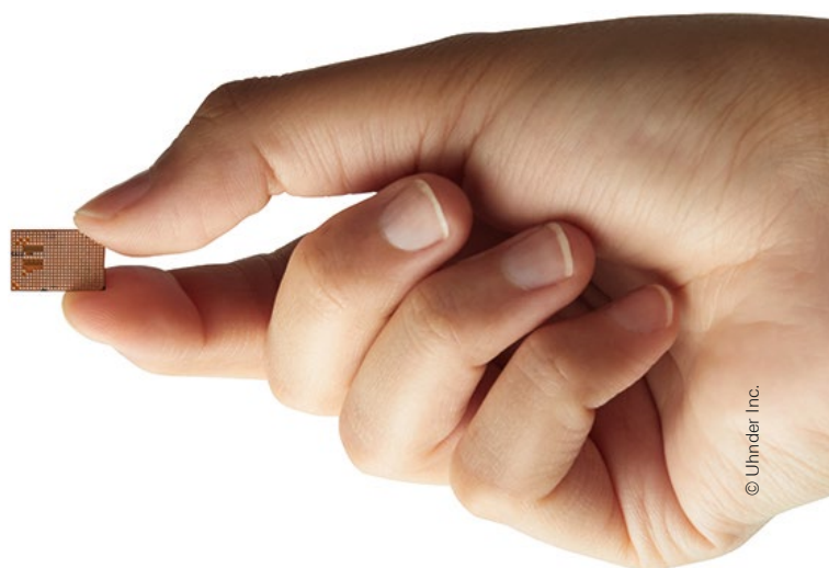
図4：信じがたいことですが、この小型チップが、すべてのシグナルプロセッシング回路を備えたオールインワンのマルチチャネルレーダーです。足りないのはアンテナだけです。
