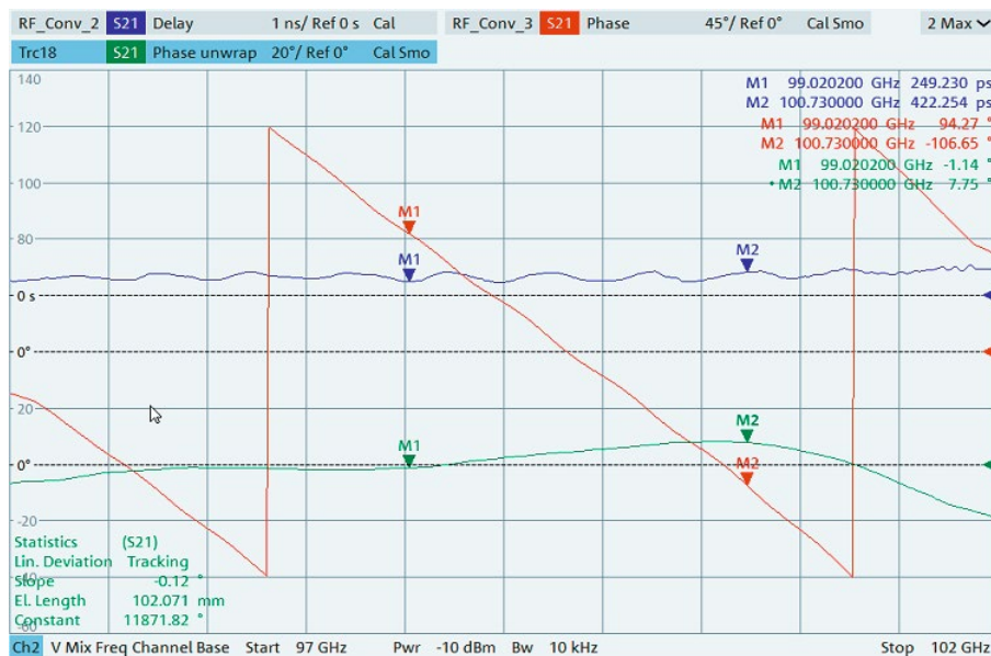
図3：被試験ミキサーの位相(赤)、リニア位相からの偏差(緑)、群遅延(青)。
