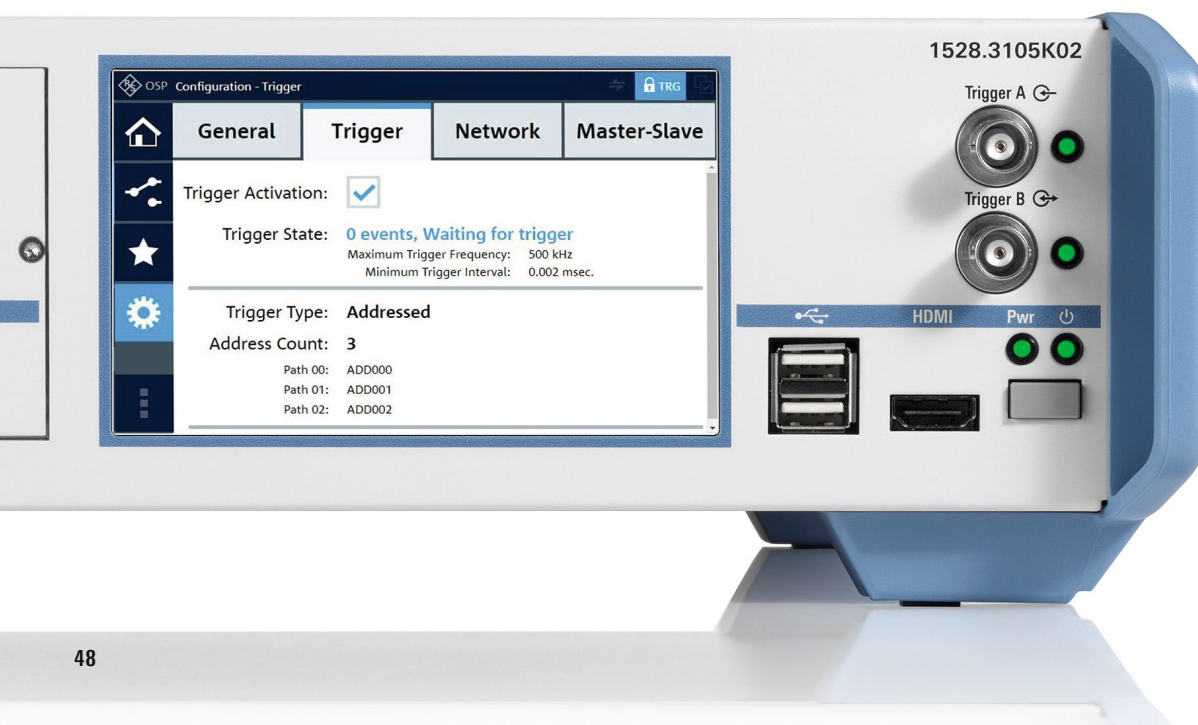
図1:トリガメニューには、特定のパス構成で可能な最短のトリガ間隔が表示されます。
