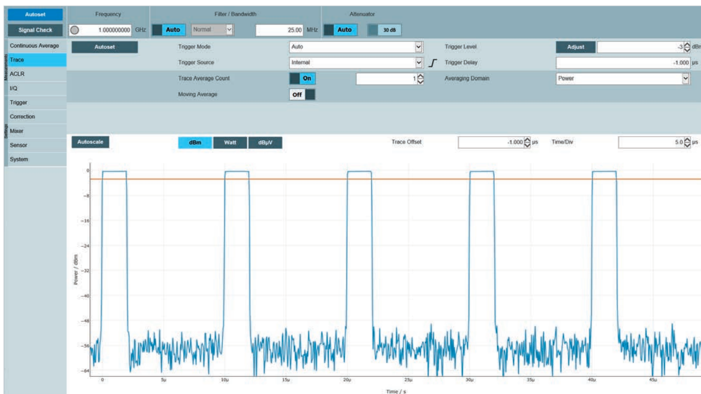
図3：ブラウザベースのGUIに表示されたトレース測定。
