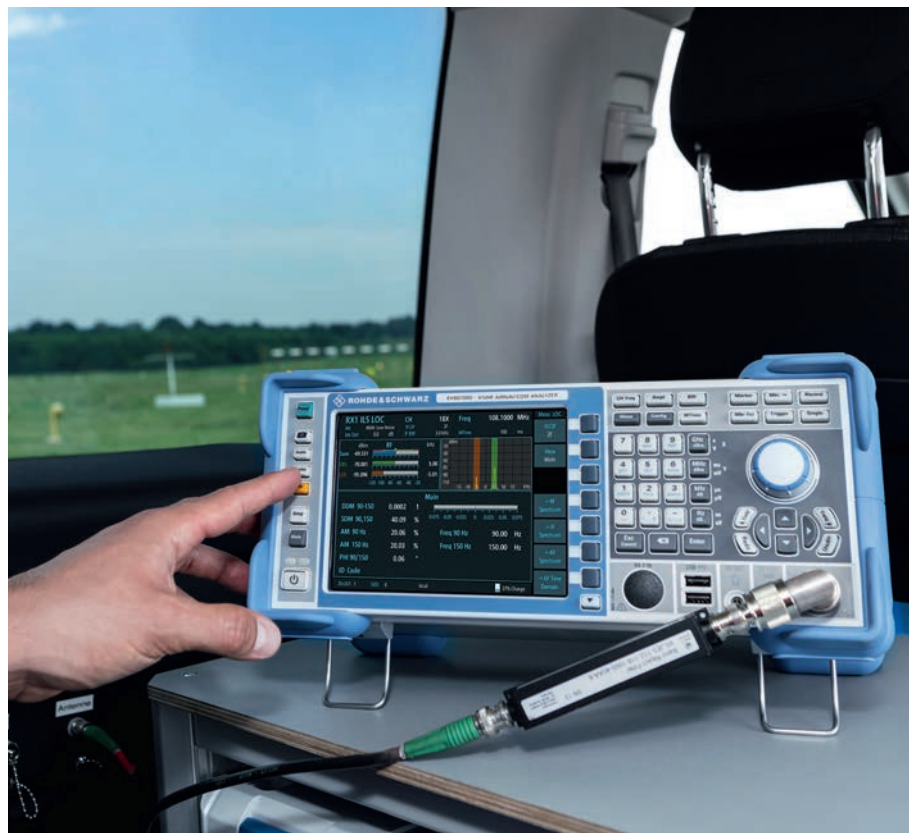
図3：R&S®EVSF1000 (左) とR&S®EVSG1000 (右) は内部機構がほぼ同一なので、比較測定に最適です。R&S®EVSG1000は、地上検査用に設計されています。
