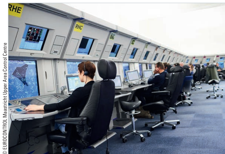
図2:ユーロコントロールのMUACの航空管制官(81ページの囲み部分を参照)が、レーダースクリーンに重ね表示されたDF情報を参照しています。
