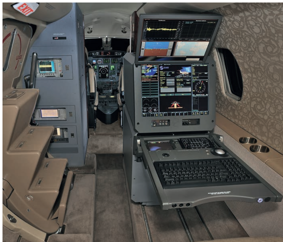
図7：飛行検査システムでのR&S®EVSF1000の代表的な設置例(写真：Norwegian Special Mission)。
