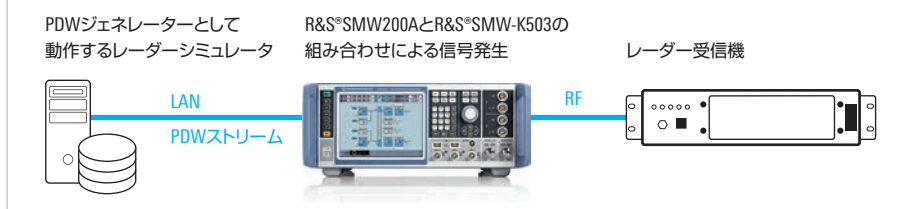
図1：単一チャネルレーダー受信機のテストの代表的なセットアップ。
