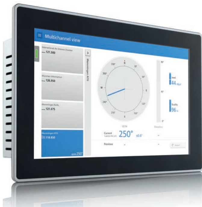
図3：タッチパネル付きのフラットなシステムPCは、設定とDF表示用に使用されます。小規模な飛行場（通常はレーダーが装備されていません）の航空管制では、現在通信中の航空機を極座標ダイアグラムに表示できます。
