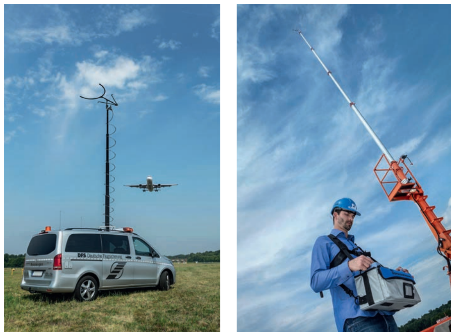
図2：ローカライザーの地上検査を行う際には、特定の高さのアンテナを使用することが推奨されています。これを実現するには、適切な装備を持つ試験車両を使用するのが最適です。いずれにせよ、動的な滑走路測定を行う際には、このような車両が不可欠です。グライドスロープ測定の場合は、アンテナをさらに高い位置に配置する必要があります。
