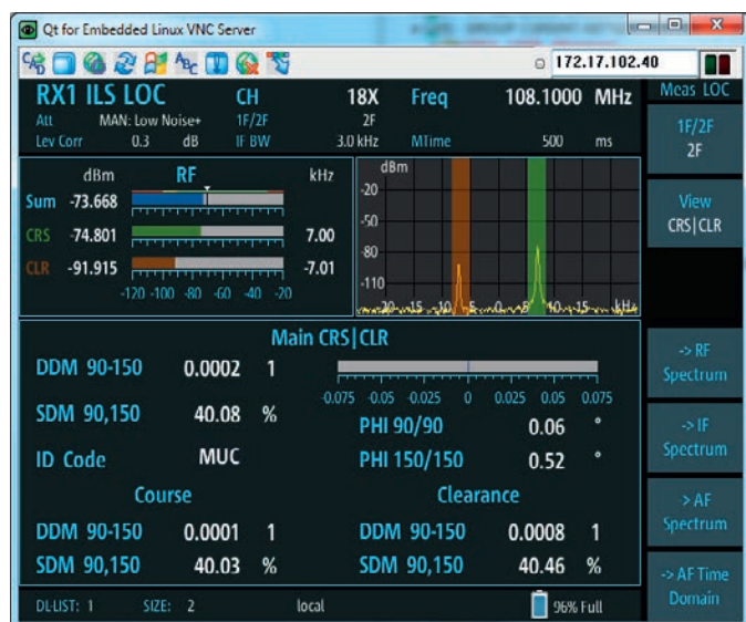
図4：2F ILS測定の結果。2つの搬送波（コースとクリアランス）のIF表示、フィルター帯域幅設定、個々の測定値（コース、クリアランス）、合計値の評価が示されています。
