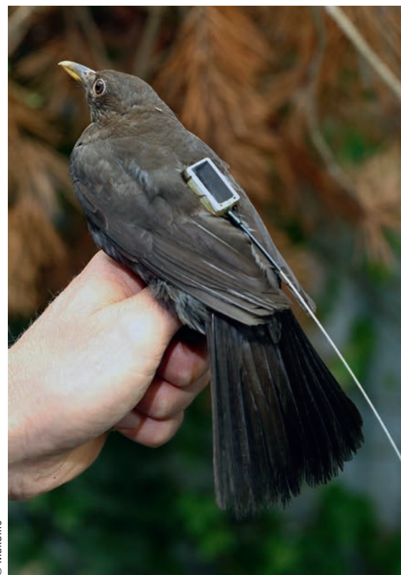
図2：クロウタドリやそれより大きい鳥なら、タグを付けても日常の活動の邪魔になりません。タグの最終バージョン(図3)はこの初期プロトタイプよりもさらに小型化されています。
