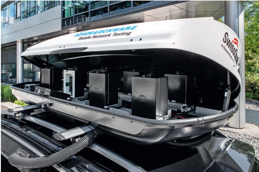
図6：車両ベースのテストキャンペーンを、包括的なモバイルカバレッジと品質マップの準備に使用可能。音声品質測定は手順の一部です。
