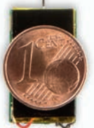
図3：ICARUSタグ（ここに示すのはほぼ量産可能なプロトタイプで、実物大）は、Max Planck Institute for OrnithologyとI-GOSが共同で開発しました。これは自律的に動作するマルチセンサデバイスで、無線モジュールを内蔵しています（センサについては左の概要を参照）。タグは、ISSや地上基地局と通信します。
