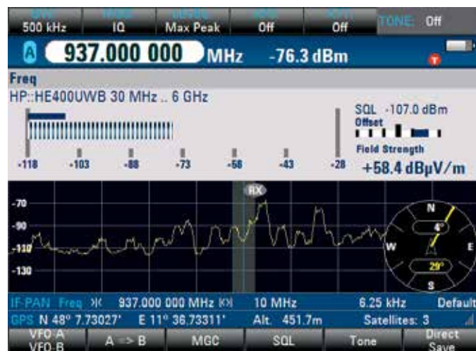
図3：電解強度、コンパス、GPSデータが表示されたPR100のディスプレイ
