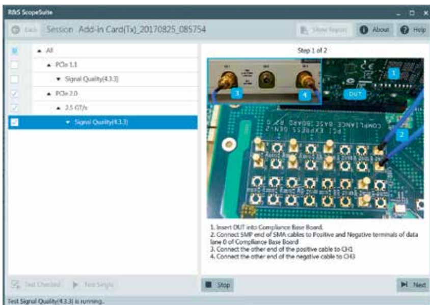
図9: ガイド付きPCIeコンプライアンステストの例(左)と詳細なレポート
