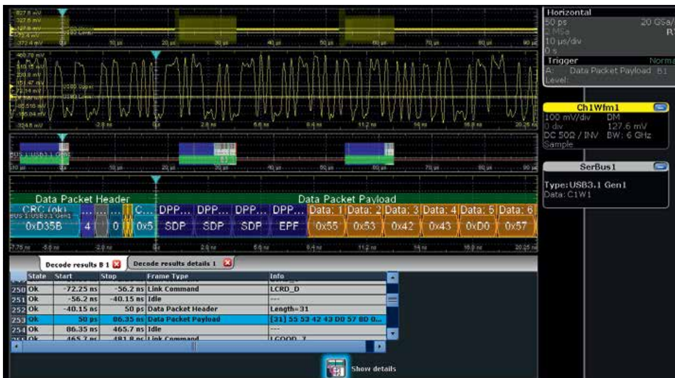
図13：USB 3.1 Gen 1に準拠したデータデコードの例
