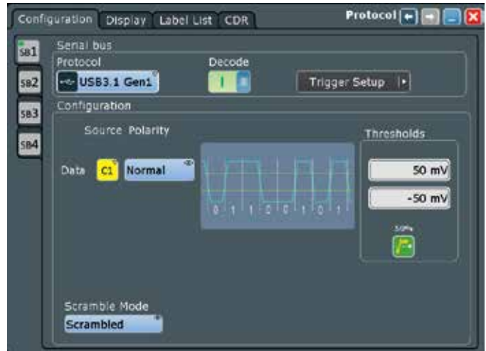
図11：R&S®RTO-K61 オプションを使用してUSB 3.1 Gen 1をデコードする場合の設定ダイアログ
