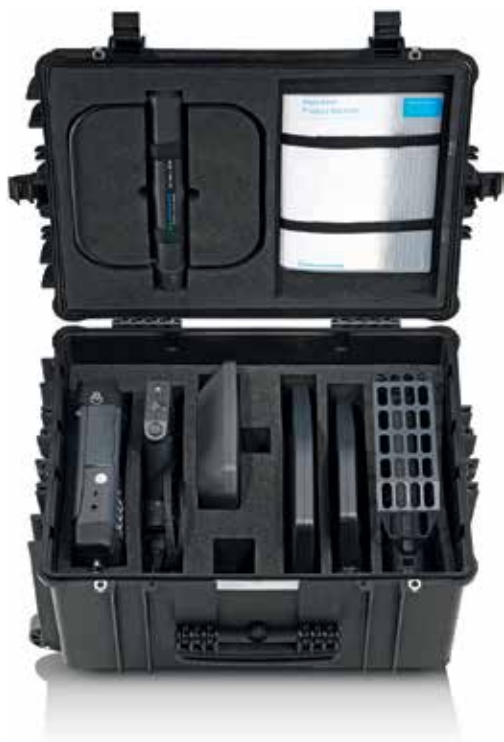
図6：すべてが手の届くところに：持ち運び用ケースには、すべてのアンテナモジュールと受信機を収納
