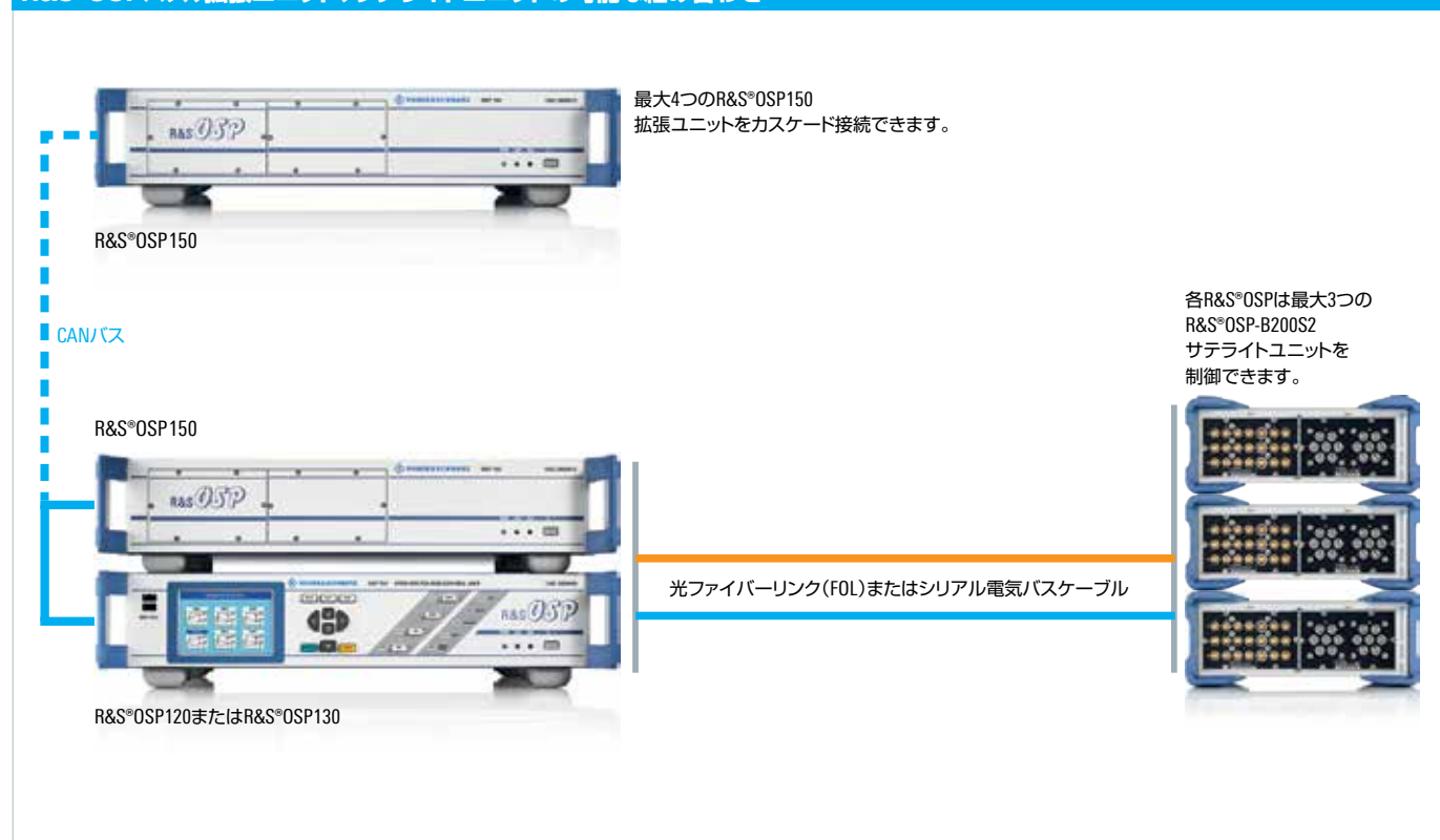
図4：R&S®OSP ベースまたは拡張ユニットにサテライトユニットを接続すると、DUTの近くで切り替え操作が行えます。
