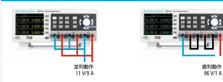
図4:複数のR&S®NGE100チャンネルを結合してより高い電圧または電流を提供できます。
