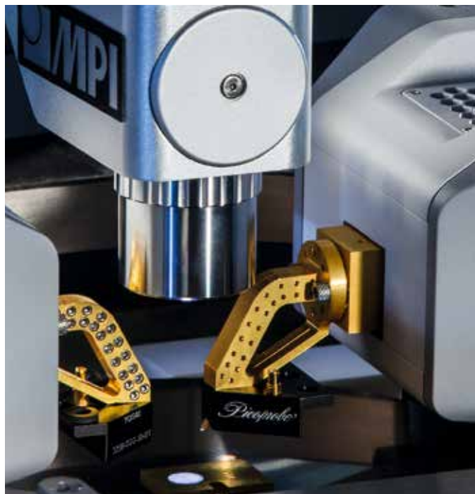
図3：ウエハーに接触するためのプローブは、コンバーターに直接ネジ止めされています。こうしたソリューションの登場により、導波管フィードスルーを用いたデザインは使用されなくなっています。
