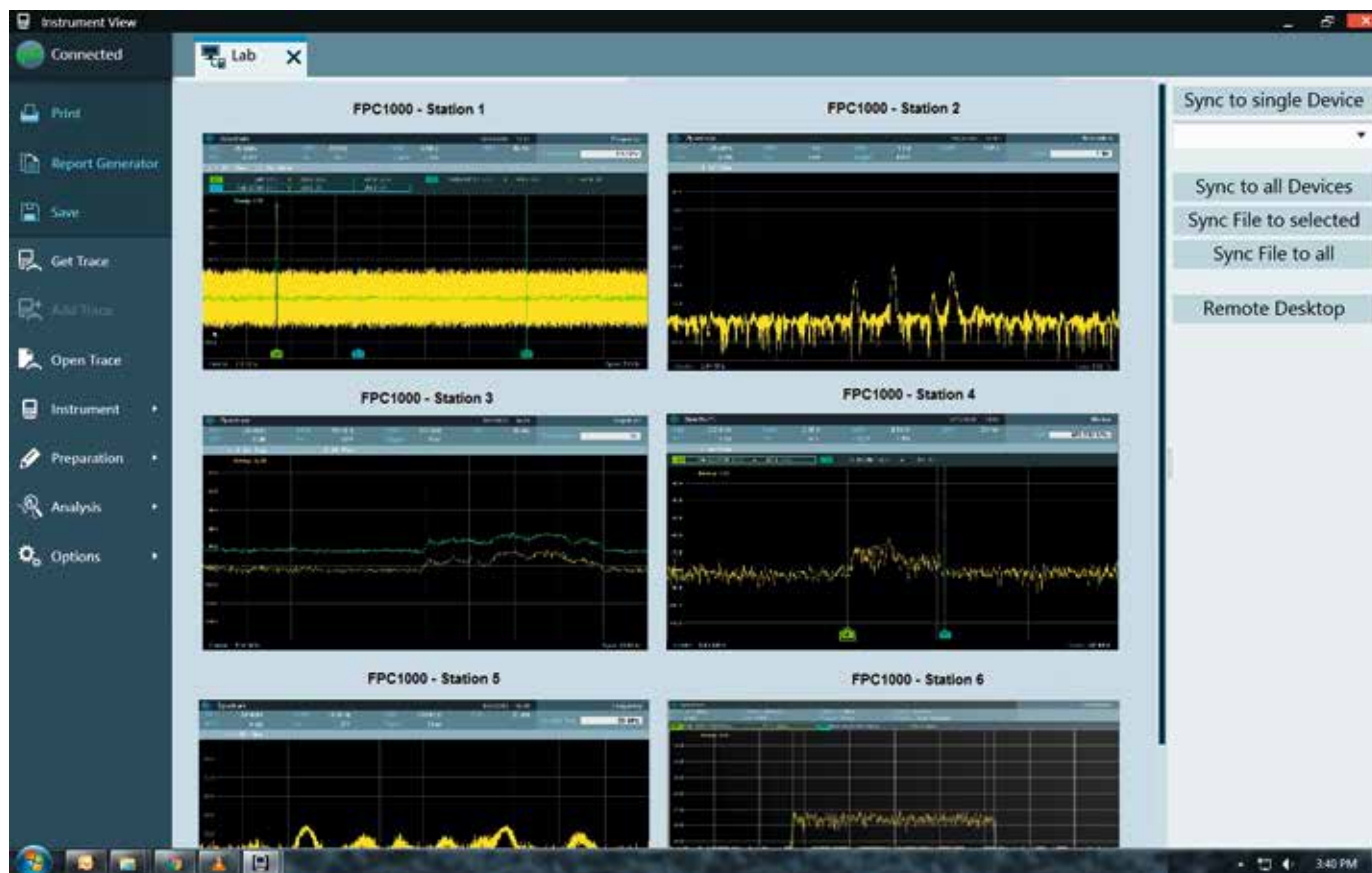
図 2 : R&S®InstrumentViewリモート制御ソフトウェアのLabView機能を使用して、Wi-Fiネットワークで複数のR&S®FPC1000スペクトラム・アナライザを管理します。
