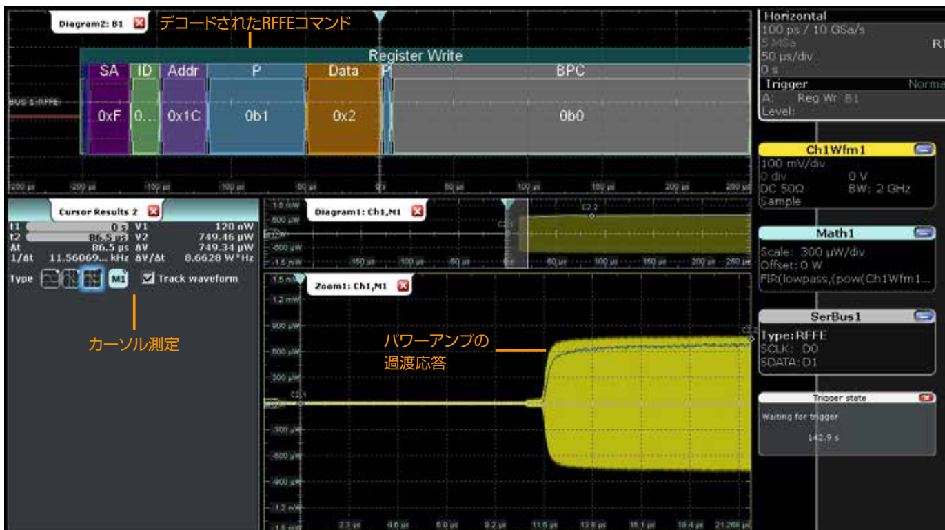
図5：RFFEで制御されるパワーアンプの過渡時間測定（マーカー付き）。オシロスコープはRFFE制御信号によってトリガされます。
