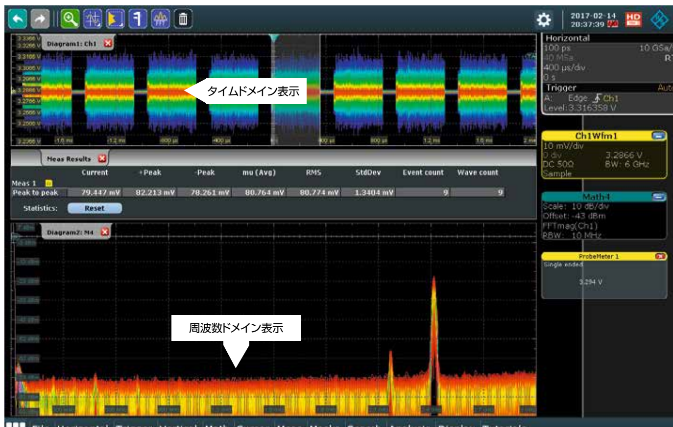
図6: ローデ・シュワルツのオシロスコープのスペクトラム解析機能は、DC電源分配回路の不要な結合信号を発見するための強力なツールです。この例では、結合された2.4 GHz無線LAN信号がはっきりと見られます。
