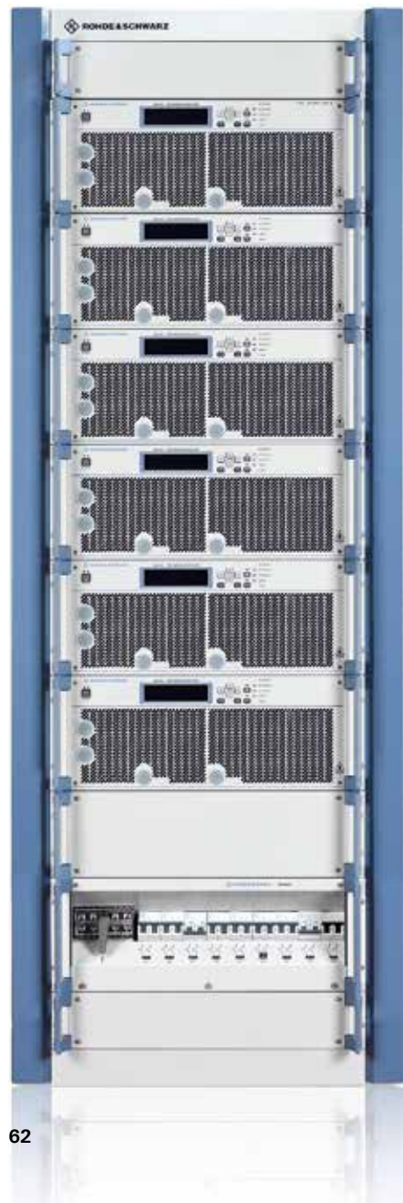
図3: 構成例: 35 HU 19" ラック内の R&S®BBA130-BC1500D1200アンプ・システムに、80 MHz ~ 1 GHz (1500 W) と 690 MHz ~ 3.2 GHz (1200 W) のパワー・アンプ、入力スイッチ、出力スイッチ、および サンプル・ポート・スイッチが含まれています。
