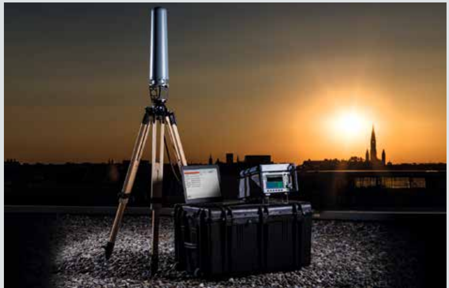
R&S®ARDRONIS-IIは、半径1 km以内における民生用ドローンのリモート制御を短時間で確実に検出できます。
