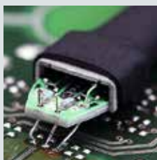
図3: どのアプリケーションでも、DUTへの接触に適切なチップモジュールを使用できます。
