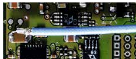
図4：広帯域測定用のはんだ付けビッグ・テール同軸ケーブル。
