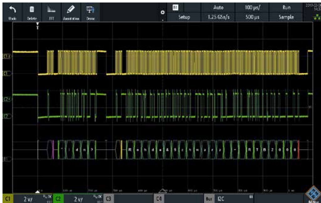
図3：大容量メモリによる長時間の信号シーケンスの捕捉。これはデータ・テレグラムおよびシリアル・プロトコルを解析する場合に特に便利です。
