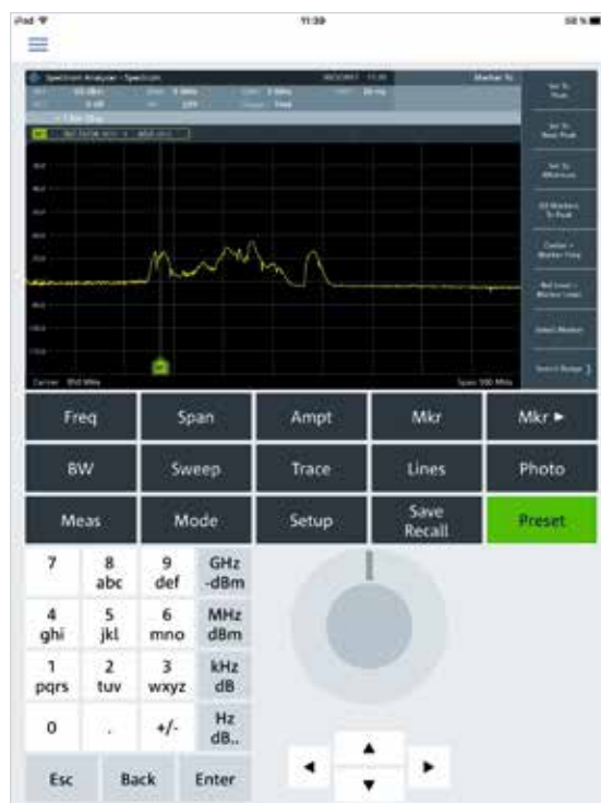
図 3 : iOSおよびAndroidデバイス用のR&S®MobileViewアプリで、R&S®FPC1000をリモート制御します。
