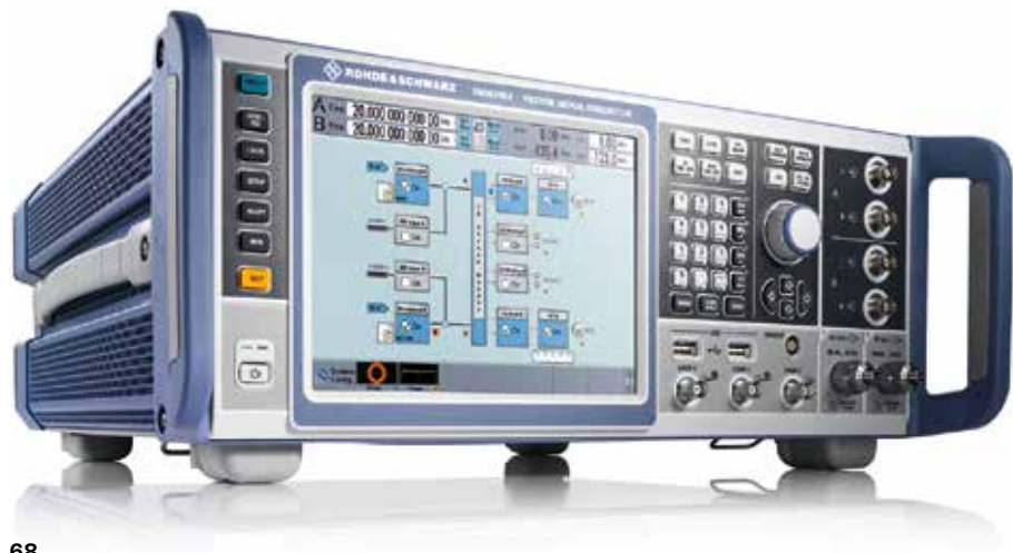
図1: R&S®SMW200Aには、DVB-S2/DVB S2Xコンポーネントおよびレシーバーの物理層テストのための信号を生成する新しいソフトウェアオプションが用意されています。
