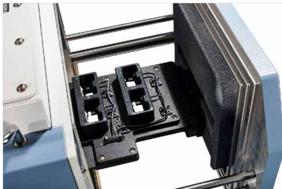
図2：4個のDUT用のテストフィクスチャ。 フィクスチャは、最大8個のDUTに対応できます。
