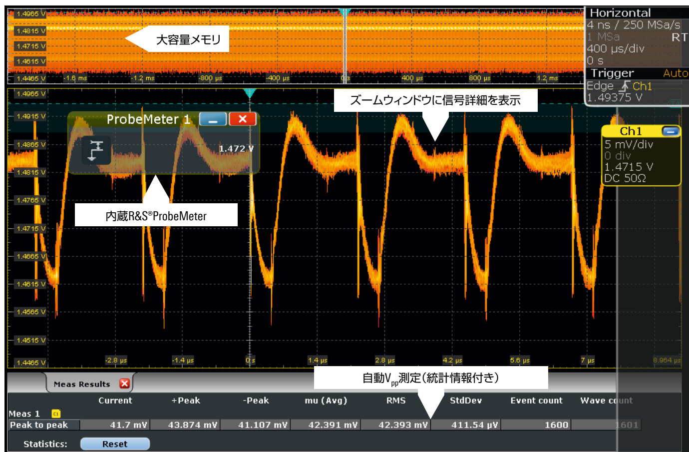
図2：R&S®RT-ZPR20パワー・レール・プローブは、R&S®ProbeMeterを内蔵しており、信号のリップル、ノイズ、過渡信号といった詳細情報と、電源分配回路の正確なDC電圧を、R&S®RTEおよびR&S®RTOで観測できます。
