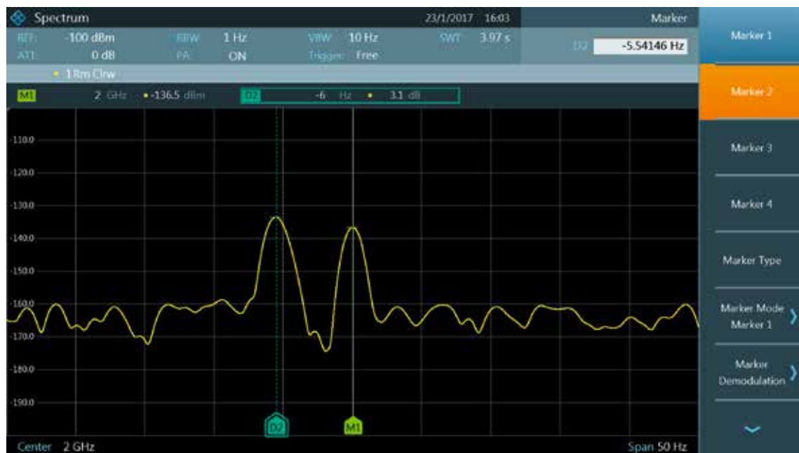
図 1: オプションのプリアンプを使用すると、R&S®FPC1000の感度は1 Hzの分解能帯域幅で、代表値-165 dBmになります。
