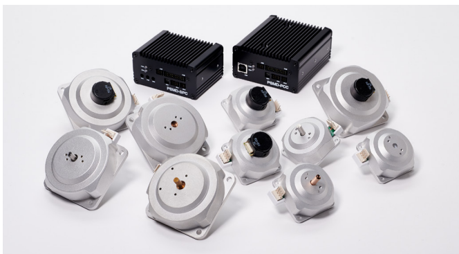
コイルや磁石を利用せず、摩擦力を利用して作動するため、小型・軽量でありながら磁場環境で利用できる超音波モータ
