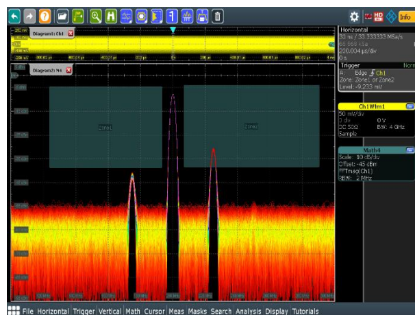
図 3: この例では、ゾーン・トリガ機能をR&S®RTO2000の周波数領域 (FFT演算結果)のスペクトラム波形に対して設定しています。オシロスコープは、側波帯の電力レベルがある規定値を超えた場合にのみスペクトラム波形を捕捉して画面に表示しています。
