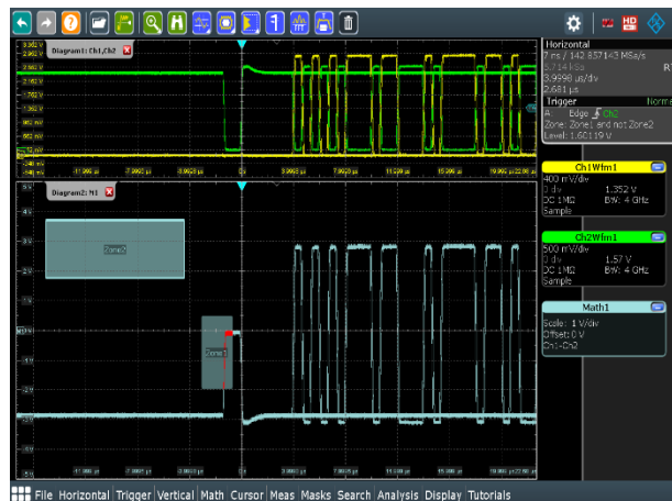
図 2: 最新のゾーン・トリガ機能はオシロスコープのチャンネル入力波形だけでなく、演算波形に対しても設定できます。この例では、R&S®RTO2000にシングル・エンド・パッシブ・プローブを2本接続し、USBのD- と D+ 信号の測定結果を画面上部に表示しています。上記2本のシングル・エンド信号を、演算機能を使用して差動信号として画面の下に表示しており、ゾーン・トリガ機能はこの演算波形に対して設定することができます。
