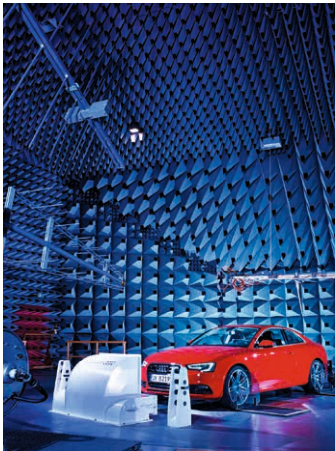
図 8: エレクトロモビリティは自動車産業に要求されるテストシナリオを広げ、5 Hz という低周波数からスタートする EMI 測定が追加されています。
