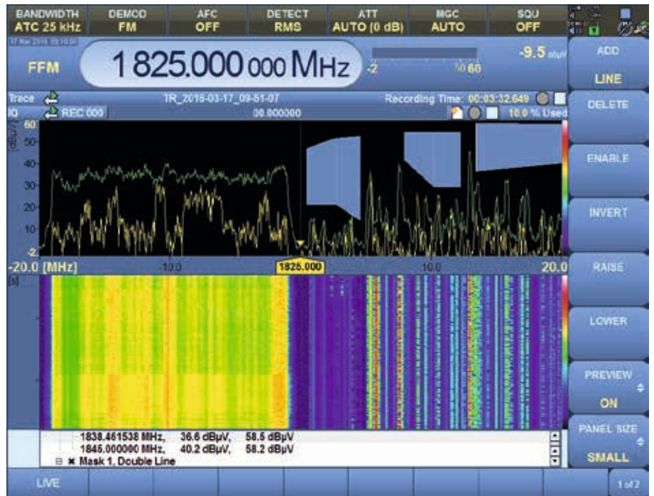
図 5 : LTE バンドの REC トリガの定義 (上段の青いエリア)。レシーバは、リアルタイム・スペクトラム (緑) と同時に、トリガ・マスクにかかるスペクトラム (黄) を表示します。
