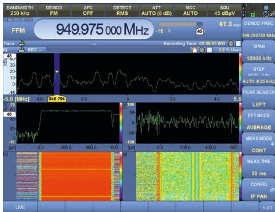
図 2 : GSM 信号の時間ドメイン表示。GSM チャンネルは、リアルタイム・スペクトラム (上段) から選択されます。時間ドメイン表示には、タイムスロット内における振幅 (中段左) と現在の変調帯域幅 (中段右) が表示され、さらに下段のウォーターフォール図にその履歴値が表示されます。
