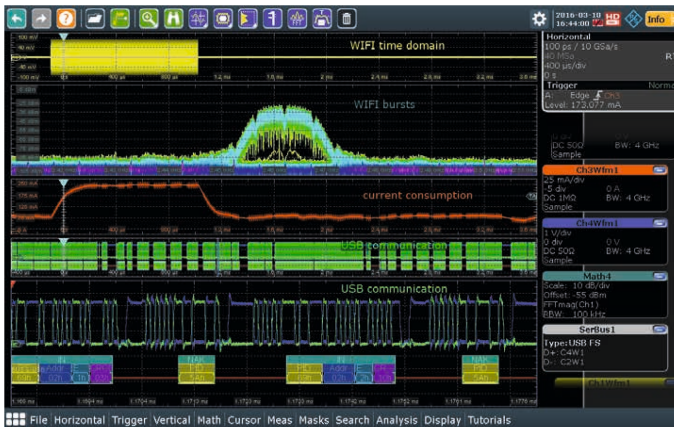
図 3: マルチドメイン・アプリケーションの例: Wi-Fi 無線モジュール、バッテリー駆動の電源、および USB インタフェースを備えた IoT モジュール
