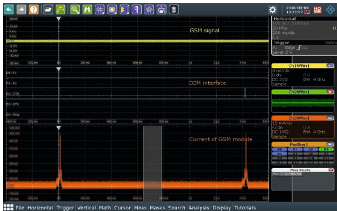
図 5: スリープ・モードにおける組み込み機器設計の消費電流の測定。基地局は、ページング (短い電流パルス) を介して GSM 無線モジュールとの通信を維持します。
