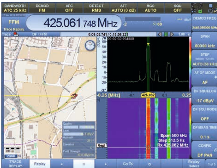
図 4：ドライブ・テスト記録の再生。マップ上でのルートおよび DF 結果の表示と、時間軸で記録されたリアルタイム・スペクトラムのウォーターフォール図
