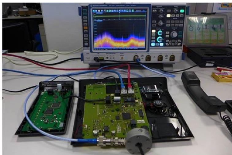
図 4-13 : ハンドセット配線上の RFI 電流計測。
