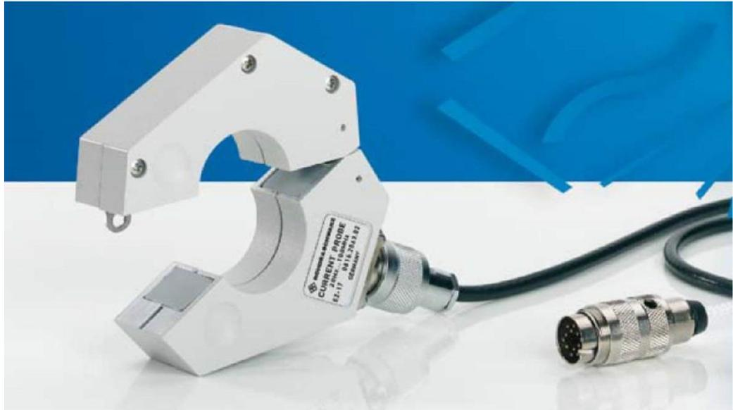
図 3-3 : 10 dBQ の伝送インピーダンス (モデル 02) または 17 dBQ の伝送インピーダンス (モデル 03) および 20Hz から 100 MHz の帯域幅を備えた R&S®EZ-17 電流プローブは、RFI 電流を計測するのに適したデバイスの好例です。30mm の大きな内径は、ケーブル束の計測を可能にしています。
