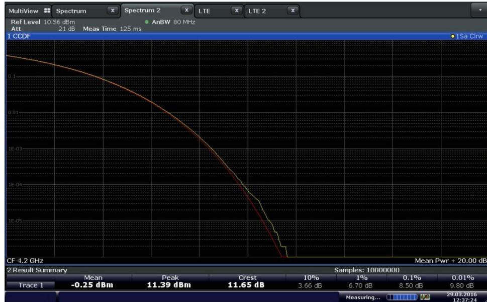
図 3-3 : 20 MHz LTE ダウンリンク信号 (E-TM 1.1) の CCDF 測定; クレストファクタ= 11.65 dB
