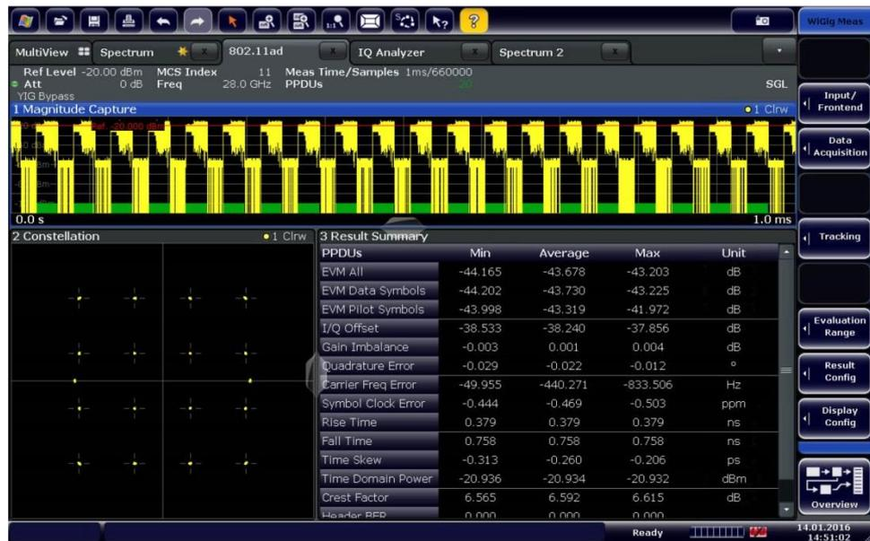
図 7-1 : PAPR (波高率) が 6.592 dB のシングルキャリア信号
