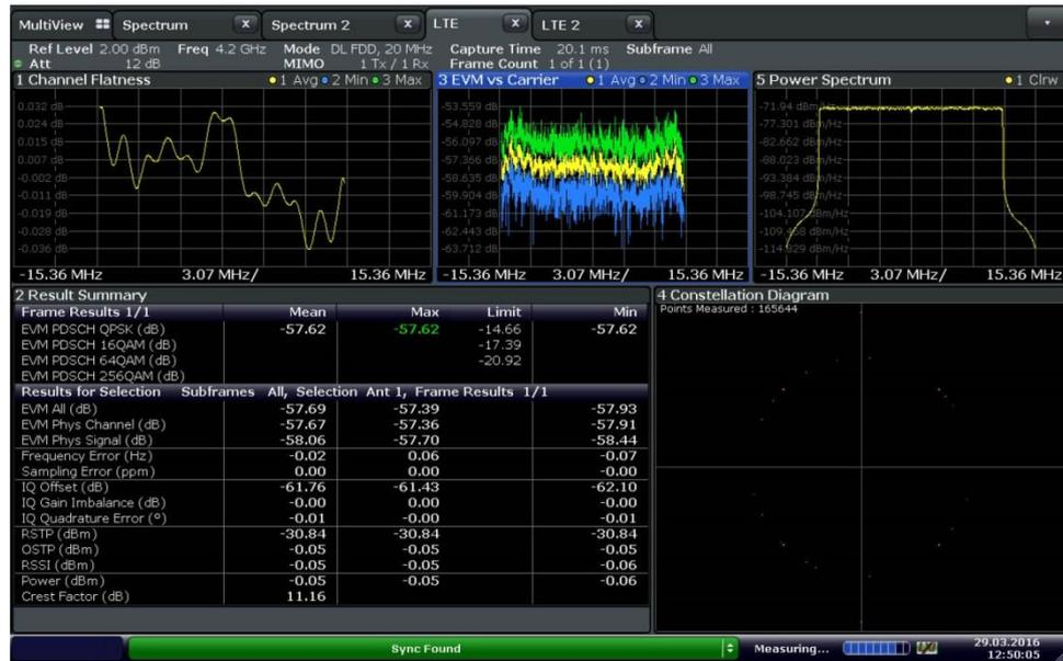
図 3-8 : 20 MHz の LTE ダウンリンク信号 (E-TM1.1) 上の信号品質計測値 (すなわち、エラーベクトルマグニチュード、EVM)
