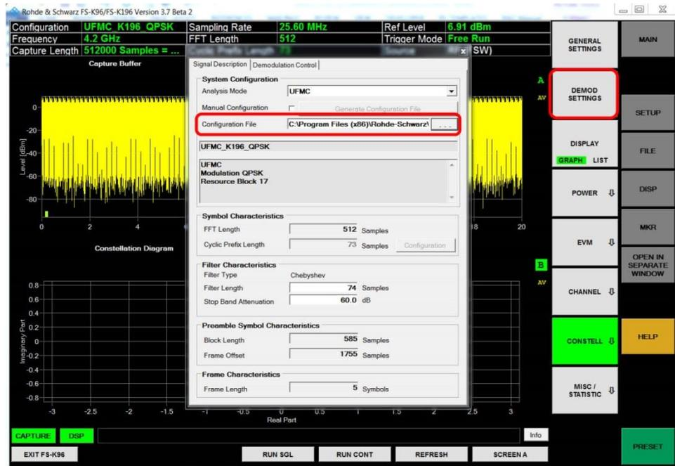
図 6-10 : 「復調セッティング」ダイアログを介して、FS-K96/FS-K196 のコンフィグレーションファイルをロードする
