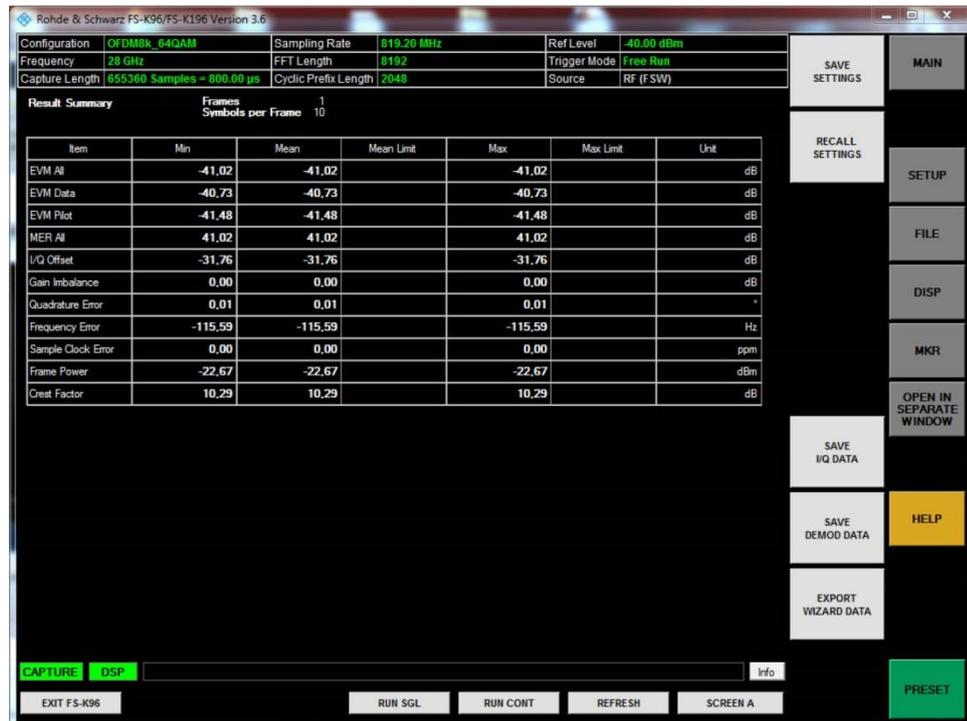
図 7-2 : PAPR (波高率) が 10.29 dB のマルチキャリア信号 (OFDM)
