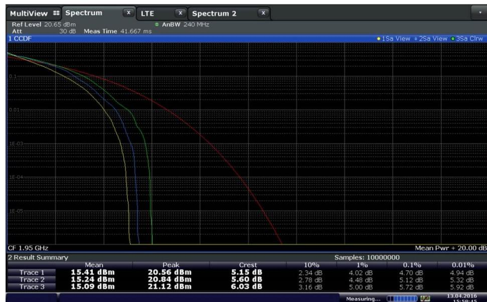
図 3-5 : QPSK (黄色; 5.15 dB 波高率)、16QAM (青色; 5.60 dB) および 64QAM (緑色; 6.03 dB) 変調を使用して割り当てられた 100RB、20 MHz LTE アップリンク信号に対する CCDF 計測<sup>6</sup>; 赤い曲線: 正規分布
