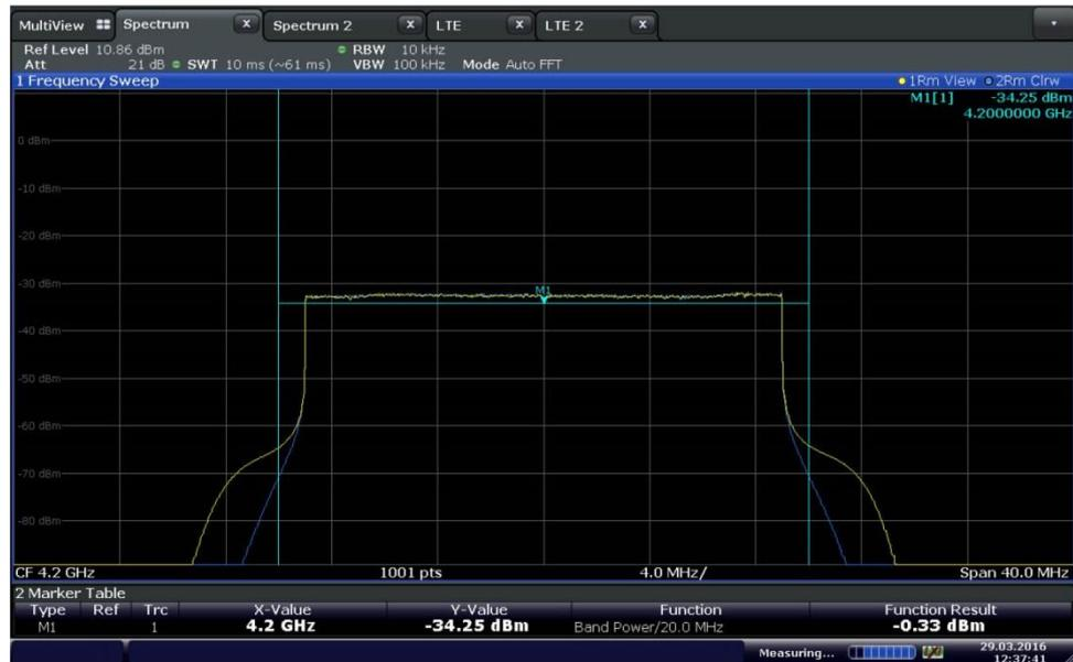
図 3-7：時間領域ウィンドウイング（青色の曲線）を適用しながら、20 MHz の LTE ダウンリンク信号（黄色の曲線）へのスペクトル改善
