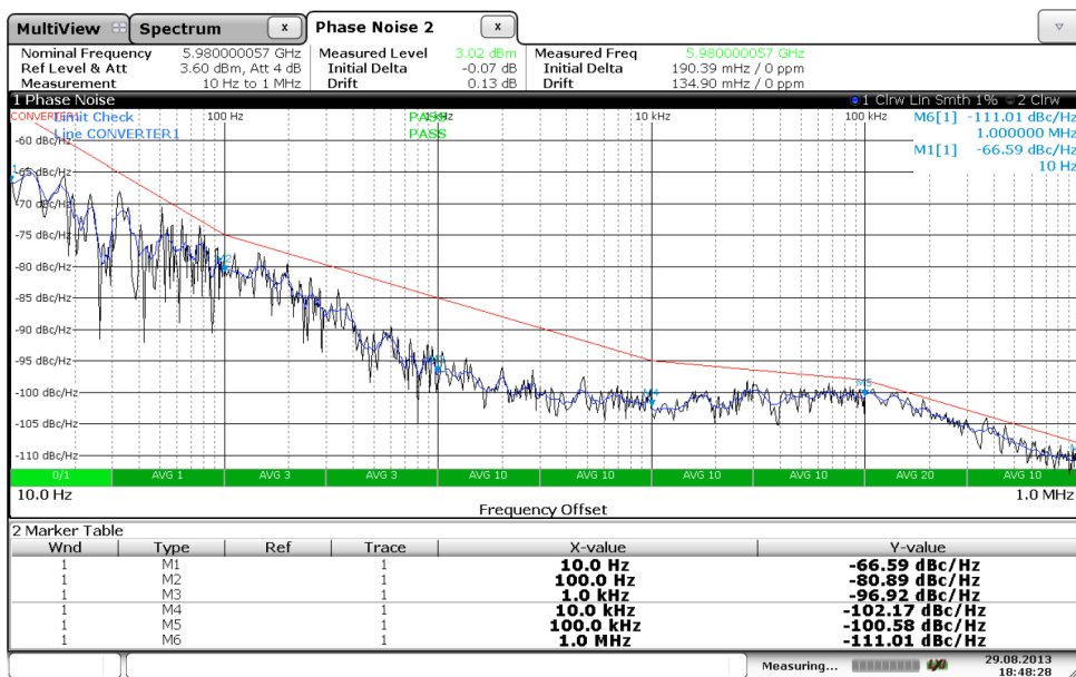
図6-23: 被試験コンバーターの70MHz IFでのFSWの位相雑音プロット
