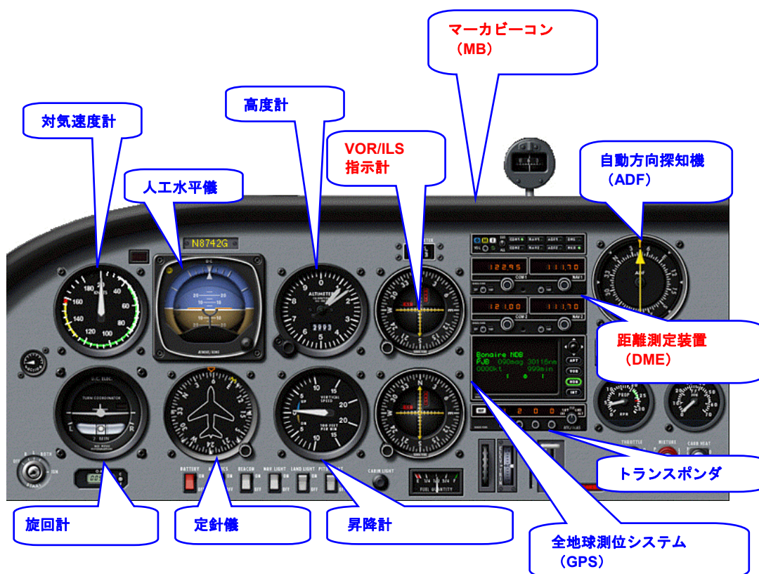
図2：操縦席の計器盤に取り付けられた各種航法、着陸、およびDME計器
