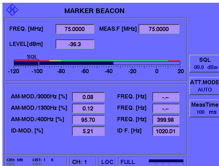
図 34 : AF オーディオ出力機能とスケルチ機能を備えた R&S®EVS300 のマーカビーコン解析
