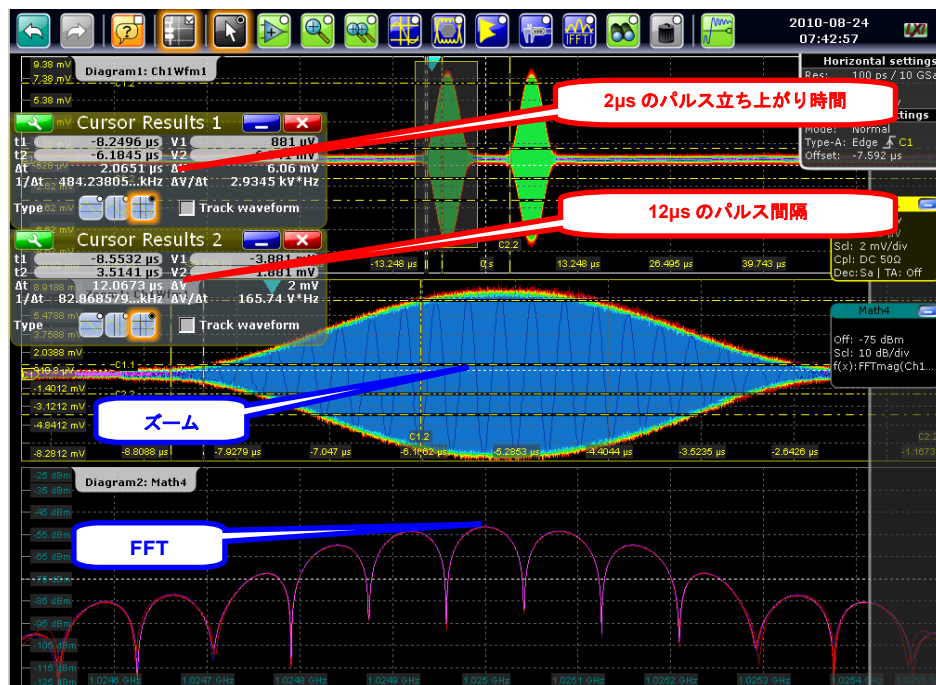
図 45 : R&S®RTO デジタル・オシロスコープによる DME パルス解析と FFT スペクトラム
