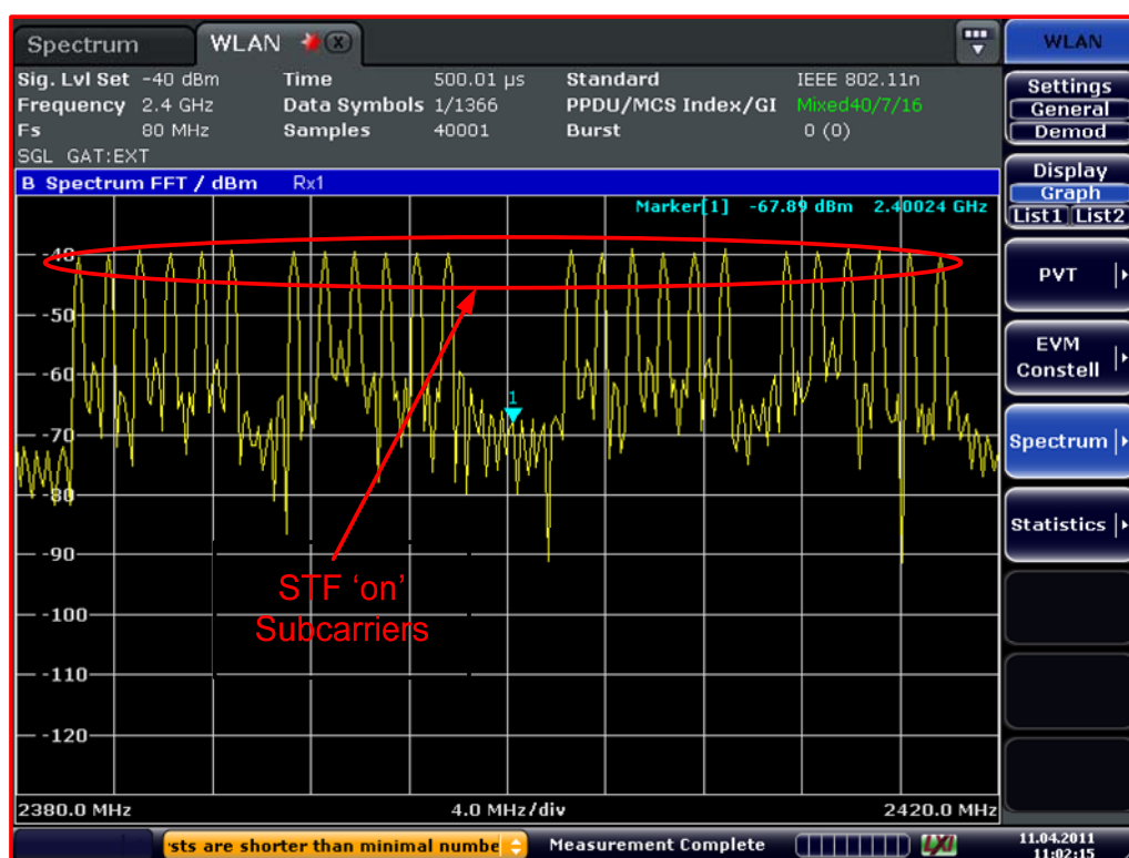
図 7: スペクトラム・アナライザ画面上での VHT STF プリアンブル
