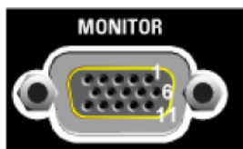
図 27 リア・パネルの MONITOR/VGA コネクタ
