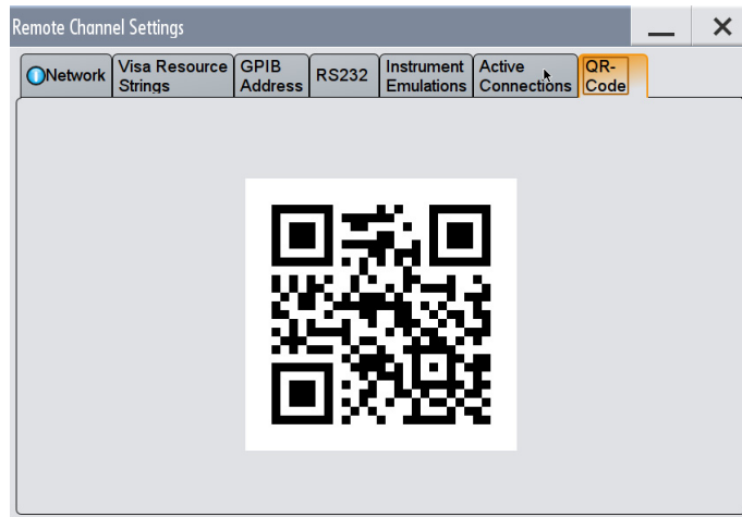
図 26 QR コードで表示された計測器アドレス (SMW のみ)
