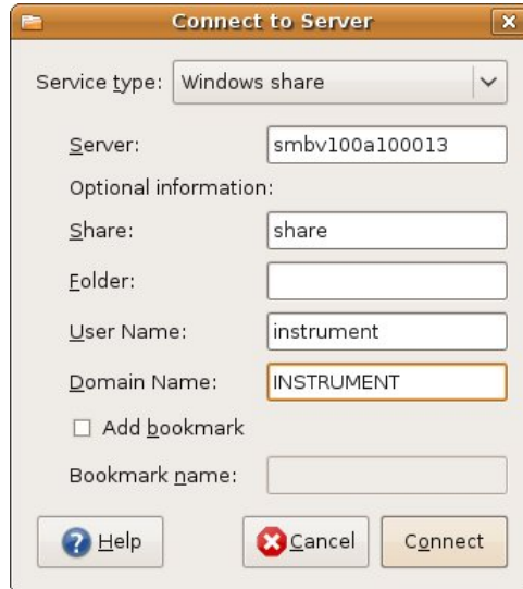
図 36 SMB/SAMBA 接続を確立する (ステップ1)
