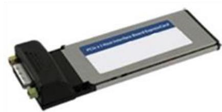
図 4 : PCI Express - PCIe x1 ケーブル・アダプタ
