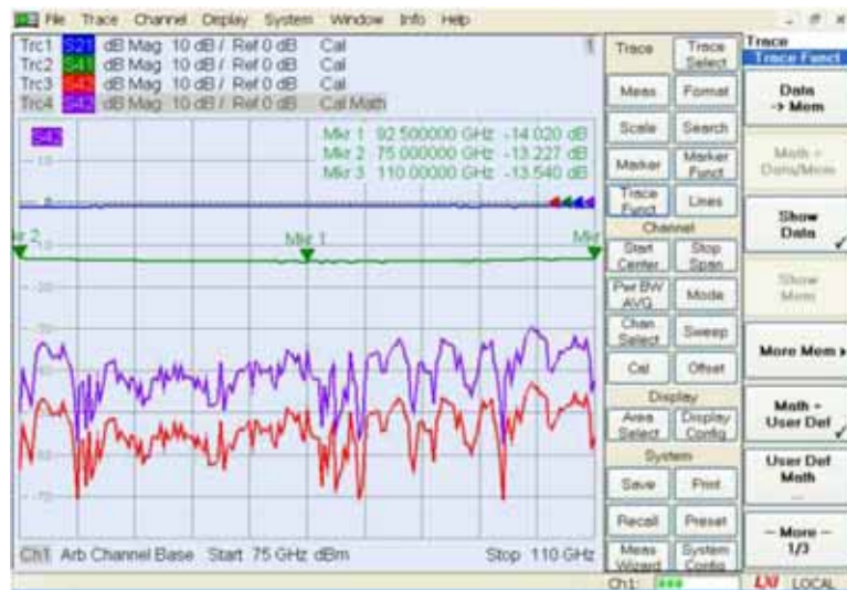
図 4.12 被測定物の挿入損、結合損、分離度、および方向性
