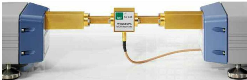
図 4.16 2 つの R&S ZVA-Z110 コンバータ間に装着されたアンプ
