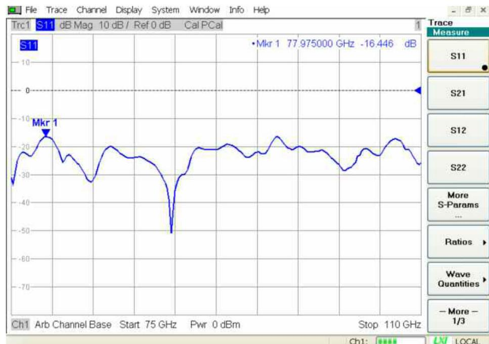
図 4.12 R&S FS-Z110 ミキサの RF ポートのリターン・ロスの測定
