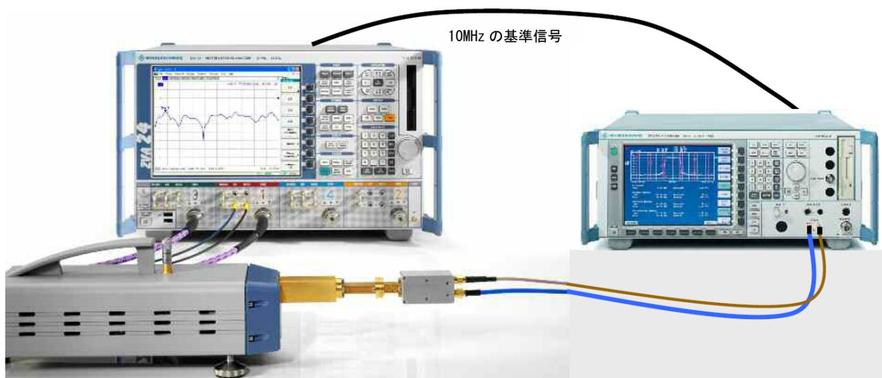
図 4.10 R&S®S-Z110 ミキサの RF マッチング測定の実験システム
