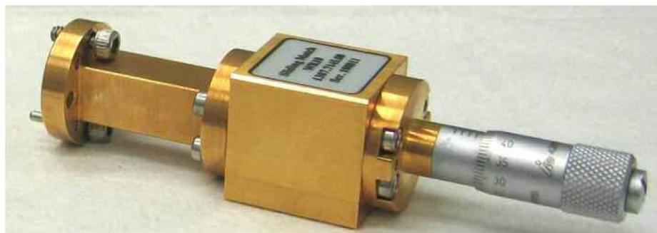
図 4.11 0.35 mm に設定された R&S®ZV-WR10 キャリブレーション・キットの導波管の *Sliding Match*
