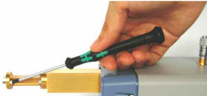
図 4.5 ネジによる導波管のフランジと被測定物などの接続
