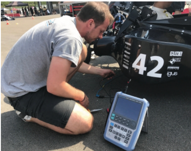
点火中断をテストするためにF17のエンジンコントロールユニットを測定するNiklas Waldstein氏
