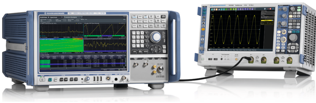
図6：外付けデジタイザとしてR&S®RTO2064オシロスコープと一緒に使用されるR&S®FSW-B5000ハードウェア・オプションを装備したR&S®FSW85信号およびスペクトラム・アナライザは、5 GHzの信号解析帯域幅を提供します。
