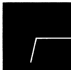
Diode in Reihe mit 51Ω
