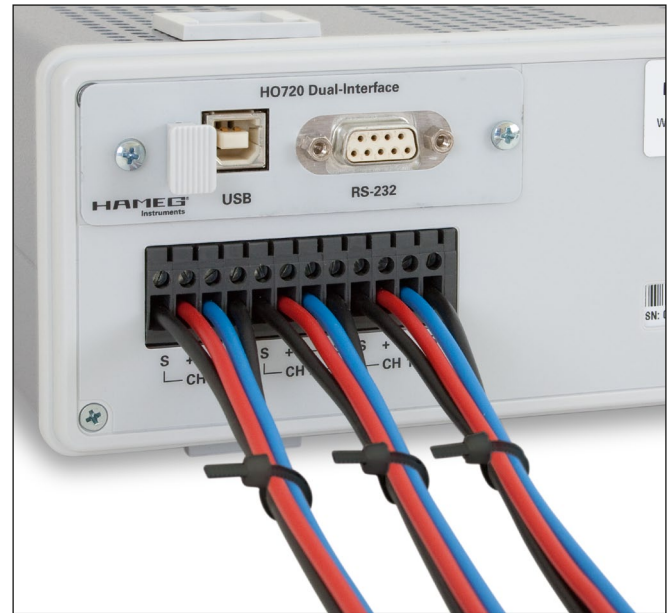
Imagen 4: Salidas posteriores para una integración sencilla en sistemas ATE.
