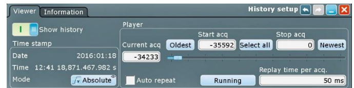
Fig. 12: La fonction d'historique permet d'accéder à toutes les formes d'onde dans la mémoire d'acquisition pour l'analyse ultérieure.
