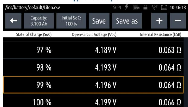
Impédance de sortie variable – par exemple, quand il est nécessaire de simuler l'augmentation de l'impédance interne comme pour les décharges de batteries.
