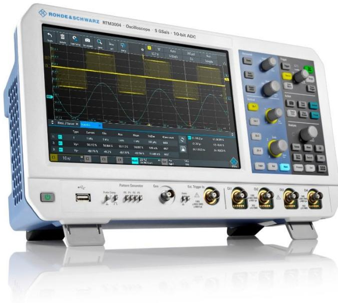
Le générateur de fonction arbitraire intégré R&S®RTM-B6 (jusqu'à 50 Mbit/s) est très pratique pour la mise en place d'essais. En complément des classiques signaux sinus, carré, triangle, impulsionnel, ou de rampe, il est capable de rajouter du bruit ou de varier la fréquence du signal (sweep). Il est également en mesure de générer une modulation AM, FM, FSK ou ASK.
