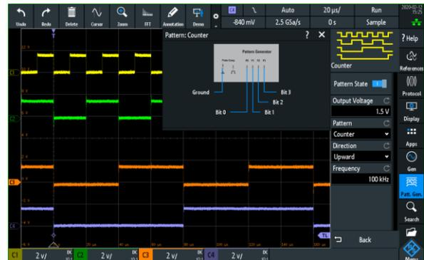
Différents types de pattern sont possibles, dont un simple carré, un « counter » (de 0000 à 1111), un pattern manuelle (définition permanente des états hauts ou bas), des bus série prédéfinis (UART, SPI, I2C, CAN, LIN, I2S, TDM, PWMxx),
