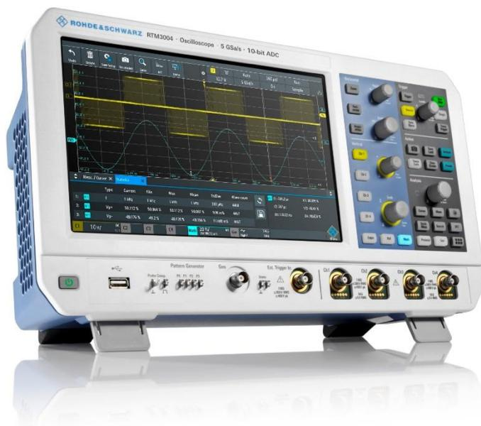
Les mesures effectuées avec l'oscilloscope RTM3000 peuvent être documentées afin d'être utilisées pour des mesures ultérieures ou pour réaliser des rapports de mesure. Ainsi, copies d'écran, paramétrage de l'oscilloscope ou échantillons des courbes acquises peuvent être mémorisés sur une clé USB connectée en face avant de l'oscilloscope.
