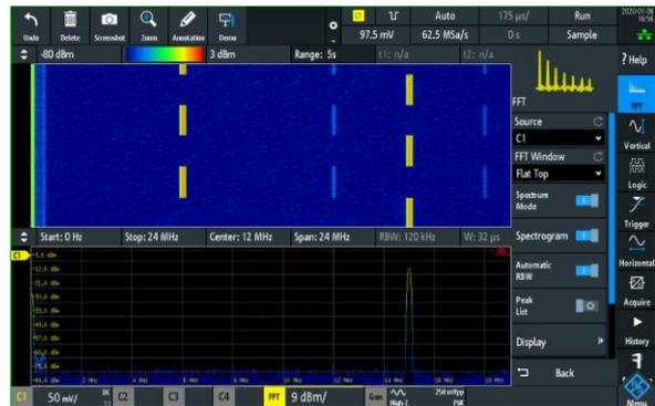
Dans l'exemple ci-dessous, la fréquence de découpage d'une alimentation est ainsi déterminée.
