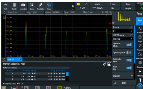
Ce montage est aussi utile pour identifier des émissions parasites et ainsi préparer un système à sa conformité en compatibilité électromagnétique (CEM), et trouver des solutions de blindage avant les tests de certification.
