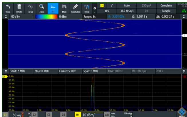
Pour mesurer des niveaux de puissance ou des écarts inter-porteuse, il est possible d'utiliser des marqueurs. « Peak List » active cette fonction, et
