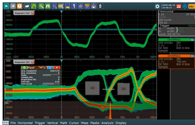
Fig. 2 : Diagramme de l'œil de cycles d'écriture DDR3 avec test du masque et histogramme.
