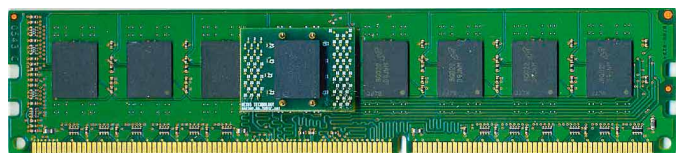
Fig. 20: Barrette DIMM avec adaptateur pour la mise en contact des signaux DDR3 au moyen d'un module de pointe de sonde à brasier.
