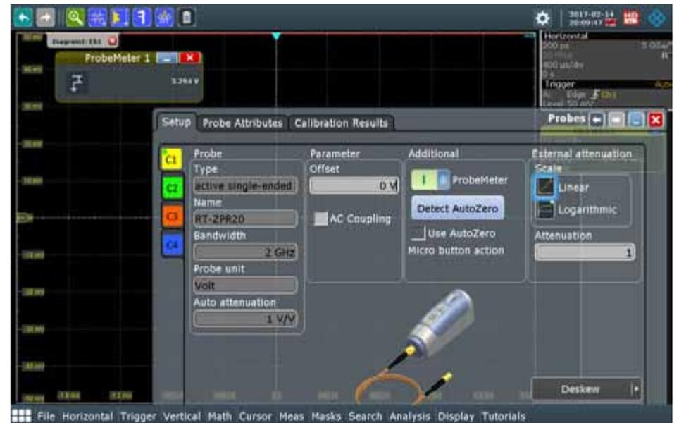
R&S®RT-ZPR20 電軌探棒包含一個一體式 R&S®ProbeMeter，即使訊號並未出現在示波器顯示器上，亦能顯示 DC 電壓，可輕易地判斷需要的偏移度，或可用於提供準確的 DC 值。
