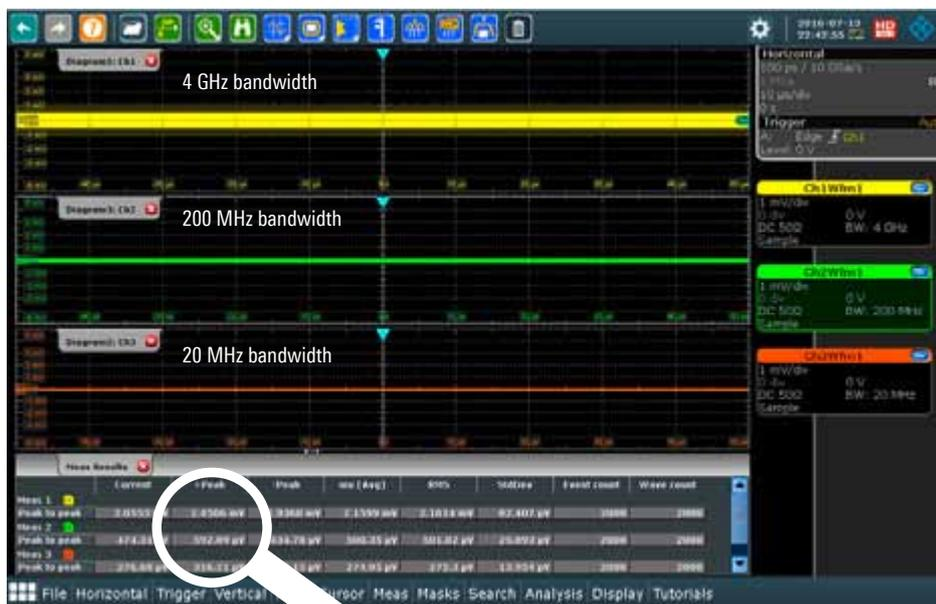
頻寬限制將寬頻雜訊降低，因此時域測量更準確。在沒有任何輸入連接至示波器頻道的情况下，此處比較了 20 MHz、200 MHz 和 4 GHz 的狀況下，在 1 mV/div 時的雜訊。20 MHz Vpp 的雜訊大約是 200 MHz 雜訊的 50%，是 4 GHz 全頻寬的雜訊量的 13%。
