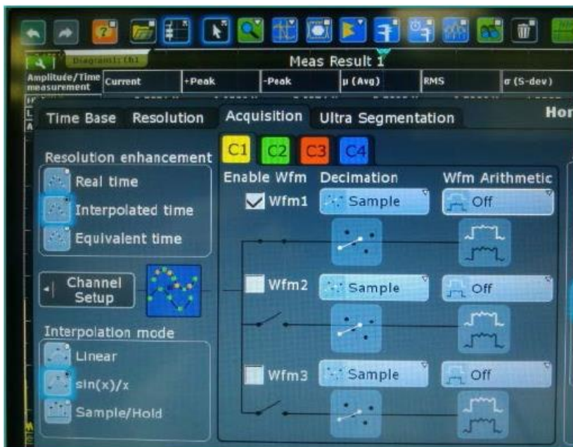
圖 1 R&S 示波器數據處理通路
