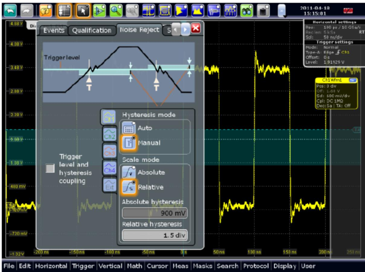
圖 10：RTO 觸發門限遲滯可以自由設定。最高靈敏度設置為 0。
