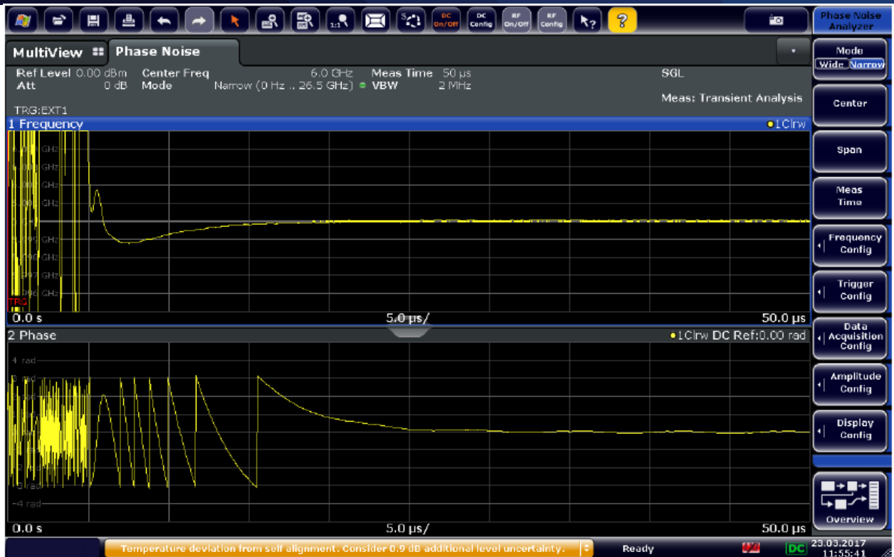
圖 12. 頻率和相位穩定時間並行測量
