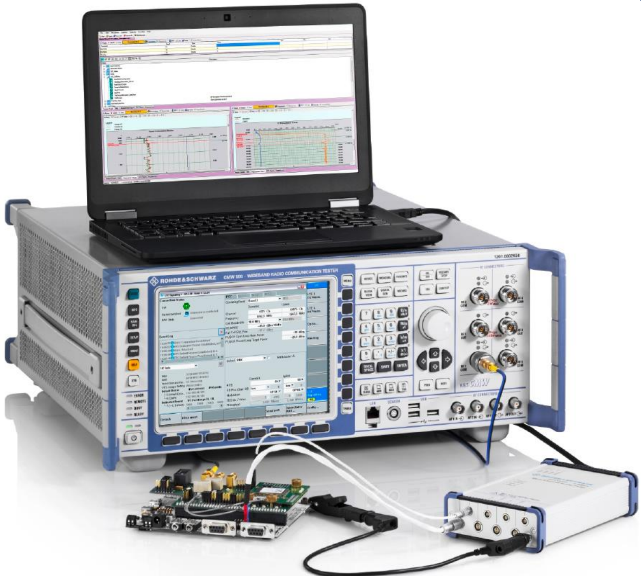
圖 2-2: 結合CMWrun、CMW500與RT-ZVC的完整IoT設備耗電測試方案
