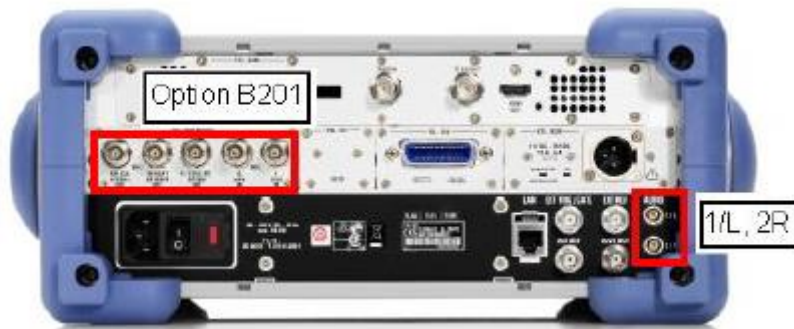
圖 13：附有 R & S@ETL-B201 硬體選件和 1/L, 2/R 端口的 R & S@ETL 後視圖。
