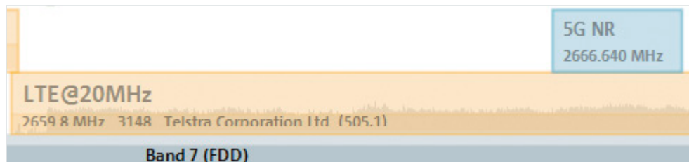
Fig.2: Compartición dinámica del espectro, portadora superpuesta LTE y 5G NR en el dominio de la frecuencia
