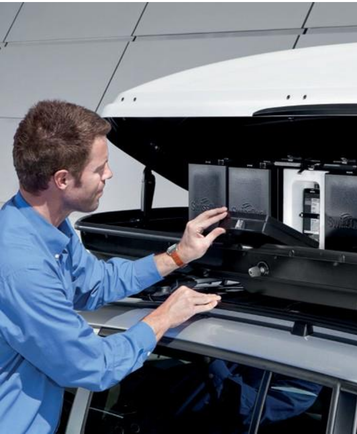
Configuración de la caja de techo del vehículo: los TCM se pueden instalar en la caja de techo del vehículo (VRB) diseñada específicamente y conectarse a Benchmarker II. El VRB puede contener hasta 16 TCM (canales de medición) y asegura condiciones uniformes de RF y temperatura. La caja de techo y el conducto de cables con clasificación IP65 para la entrada de cables en el vehículo puede soportar cualquier condición climática.
